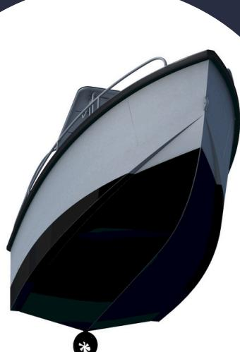
Extrêmement maniable et léger, ce propulseur développe une puissance concentrée sur la poussée. Particulièrement optimisé, son rendement de 90 % lui permet de remplacer les moteurs thermiques de 20 CV pour le 6 kW et de 50 CV pour le 14 kW.
