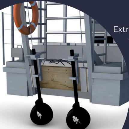
Extrêmement maniable et léger, ce propulseur développe une puissance concentrée sur la poussée. Particulièrement optimisé, son rendement de 90% lui permet de remplacer des moteurs thermiques de 50CV.
